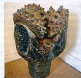
**Le trépan.** Cette tête de forage en titane a creusé à 2 000 mètres sous la ville pour installer un chauffage par géothermie pour 5 000 foyers.
